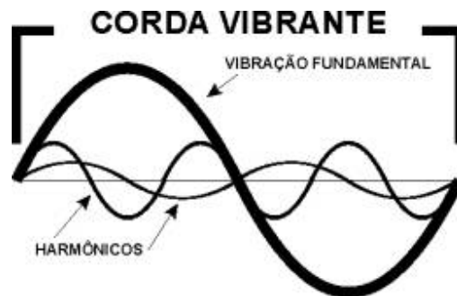
ap2.07: representação de cada um dos harmônicos de uma corda vibrando;
